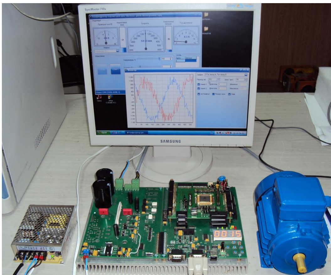
а) отладочный комплект MCB-01 с установленным модулем разработчика ИМС 1867ВЦ5Т и асинхронным электродвигателем
